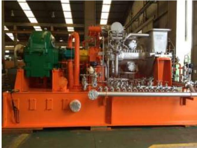
**Figura 19- Turbina a vapor de multiestágios**
