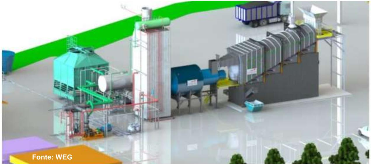
**Figura 16- Figura Esquemática da URE**
